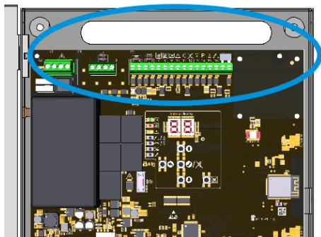
Faire passer les câbles par le passage de câbles supérieur et les câbler selon les schémas de raccordement (voir section 3.2).
