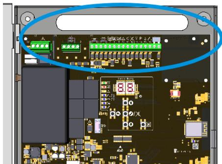
Przepuścić przewody przez górnego otwór obudowy i okablować zgodnie z planami połączeń (patrz sekcja 3.2).
