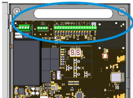
De kabels door de bovenste behuizingsoepening leiden en volgens de aansluitschema's bedraven (zie hoofdstuk 3.2).
