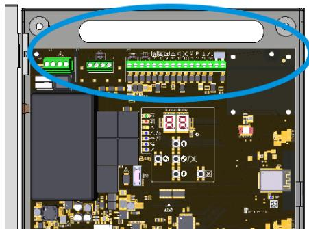
Die Leitungen durch die obere Gehäuseöffnung führen und entsprechend den Anschlussplänen verdrahten (siehe Abschnitt 3.2).
