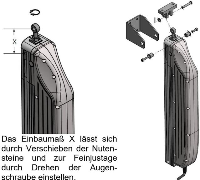
Das Einbaumaß X lässt sich durch Verschieben der Nutensteine und zur Feinjustage durch Drehen der Augenschraube einstellen.
