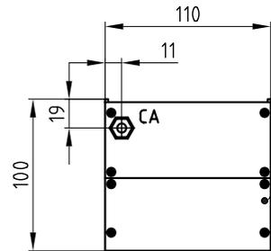
Bohrung für Verplombung
